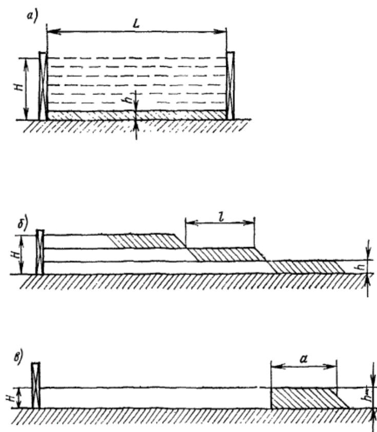
*а – последовательными горизонтальными слоями; б – схема ступенчатого бетонирования;
