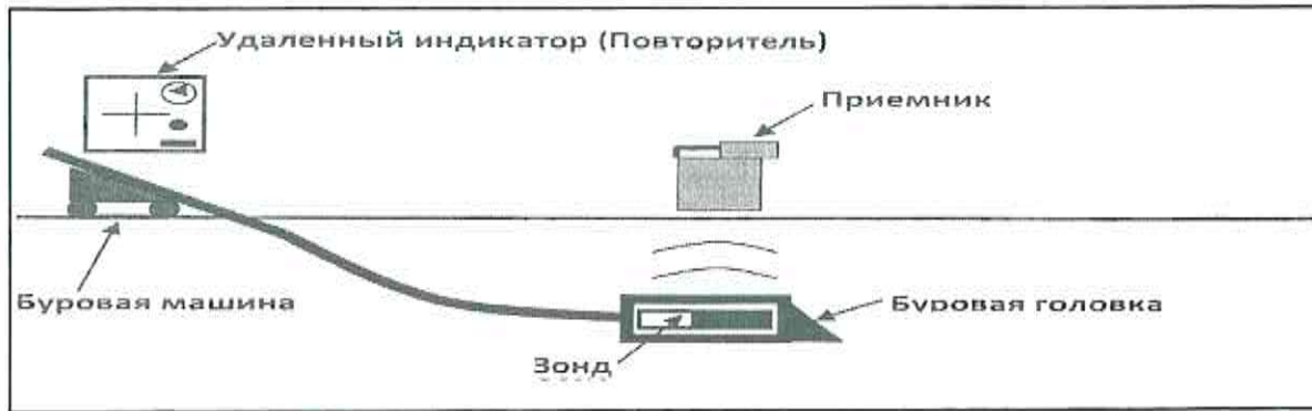
Рисунок А.2 – Схема действия электромагнитной системы подземной локализации
