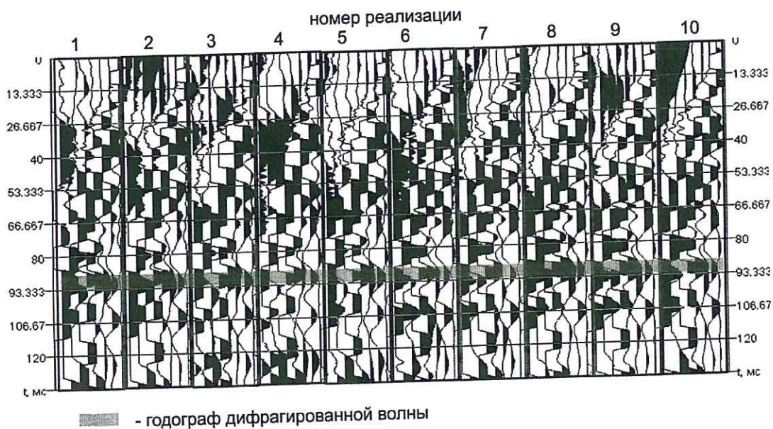
Рисунок Д.2 – Пример сейсмограммы с регистрацией дифрагированной волны
