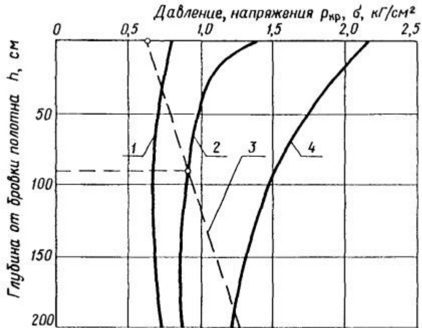
Рис. 1. Кривые распределения по глубине нормальных напряжений в грунтах основания:
